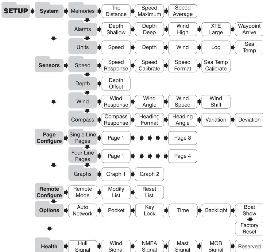
**Um das Setup- und Kalibrierungsmenü zu öffnen:** Drücken Sie die Taste für zwei Sekunden. Eine Liste von Kapiteln wird gezeigt, von denen das aktive mit dem Cursor markiert ist.
