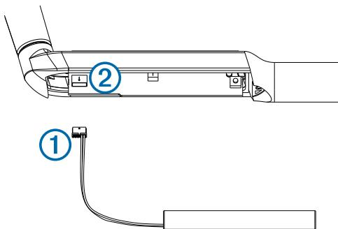
El conector encaja en el puerto en una única dirección. Si fuerzas el conector en el puerto, puedes dañarlo.
