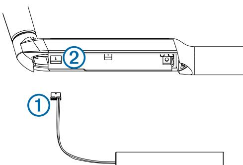
接头将以唯一的方式匹配该端口。将接头强制插入端口可能将其损坏。
