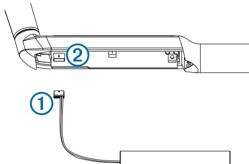
Es gibt nur eine Möglichkeit den Stecker mit dem Anschluss zu verbinden. Wenden Sie beim Verbinden des Steckers mit dem Anschluss keine Gewalt an, da dies zu Schäden führen könnte.
