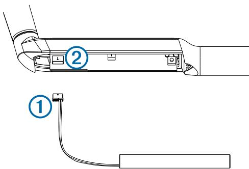
De connector kan op slechts een manier op de poort worden aangesloten. De poort kan beschadigd raken indien u probeert de connector met kracht aan te sluiten.
