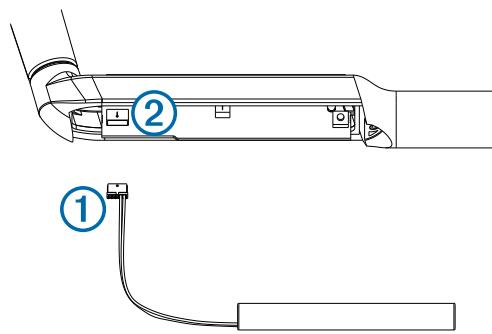
Priklučak se u utor može umetnuti samo u jednom smjeru. Primjenom prekomjerne sile prilikom umetanja priključka u utor možete oštetići priključak.
