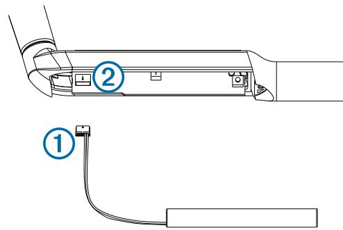
Kontakten kan endast sättas i på ett sätt i porten. Porten kan skadas om du tvingar in kontakten.
