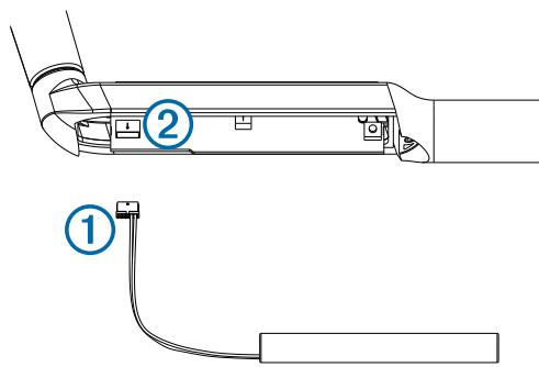
Konektor do portu zapadne pouze ve správné orientaci. Použití nadměrné síly na konektor může vést k jeho poškození.
