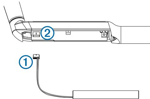
Złącze można włożyć do portu tylko w jeden sposób. Próba włożenia złącza do portu na siłę może się skończyć jego uszkodzeniem.
