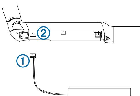
Il connettore si inserisce nella porta in un solo modo. Forzare il connettore nella porta potrebbe danneggiarlo.
