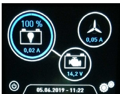
Figure 5 : Shunt #1 avec mesure de tension additionnelle (+2) et shunt #2 en mode Energie
